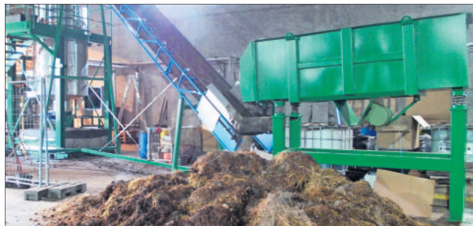
▲ Dave Tjik (28), Gründer der Jettinger Firma Smartcarbon, verwertet Bioabfälle. Daraus stellt er Kohleprodukte her, um Energie zu erzeugen und Flüssigdünger. Die Technologie funktioniert vereinfacht so: In einer Art Schnellkochtopf lässt er Bioabfälle zusammen mit Wasser kochen. Nach mehreren Stunden entsteht ein wässriger Schlamm, der weiterverarbeitet wird. „Mit unserem Bodenverbesserer lassen sich sogar Wüsten ohne den Einsatz von Gentechnik begrünen“, sagt Tjik. Das mehrere Millionen teure Reaktorsystem will die Firma nun vermarkten. Foto: Smartcarbon
